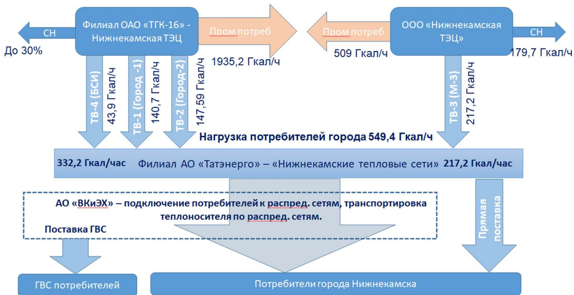
Рис. 1.3. Функциональная структура системы централизованного теплоснабжения города Нижнекамска
